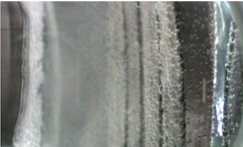
Abbildung 3: Gasentwicklung am Magnesiumband
