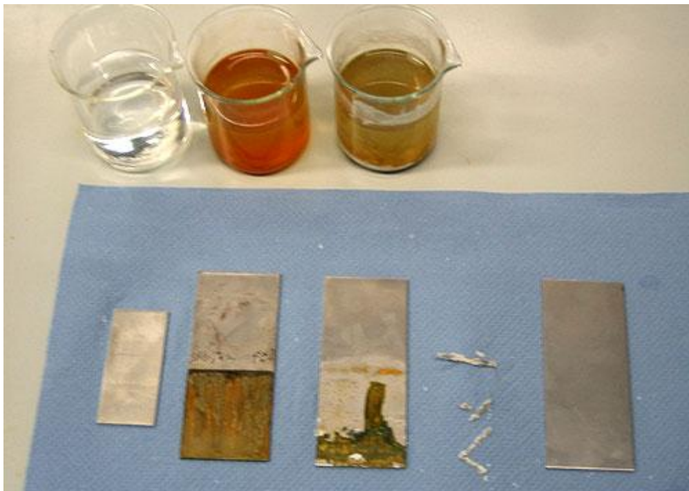
Abbildung 6: Probenkörper nach 20 Stunden im Salzwasser. Von links nach rechts: 1. Edelstahl, 2. Stahl, 3. Stahl mit Magnesiumband, 4. Reste des Magnesiumbandes, 5. Vergleichsprobe
