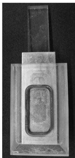
Bild 3.2: Probenhalter für die Anodisation (Herstellung und Bild: Fraunhofer IKTS, Dresden)
