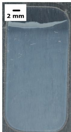
Bild 5.22: Makroskopische Oberflächenaufnahme einer MPAA-Schicht ( $dE/dt=300$  mV/s, Haltezeit 420 s) auf AA 1050, imprägniert mit LEVASIL<sup>®</sup>300/30% (pH 10, Raumtemperatur), Tauchbeschichtung, Ziehgeschwindigkeit 15 mm/min, Tauchzeit 10 min
